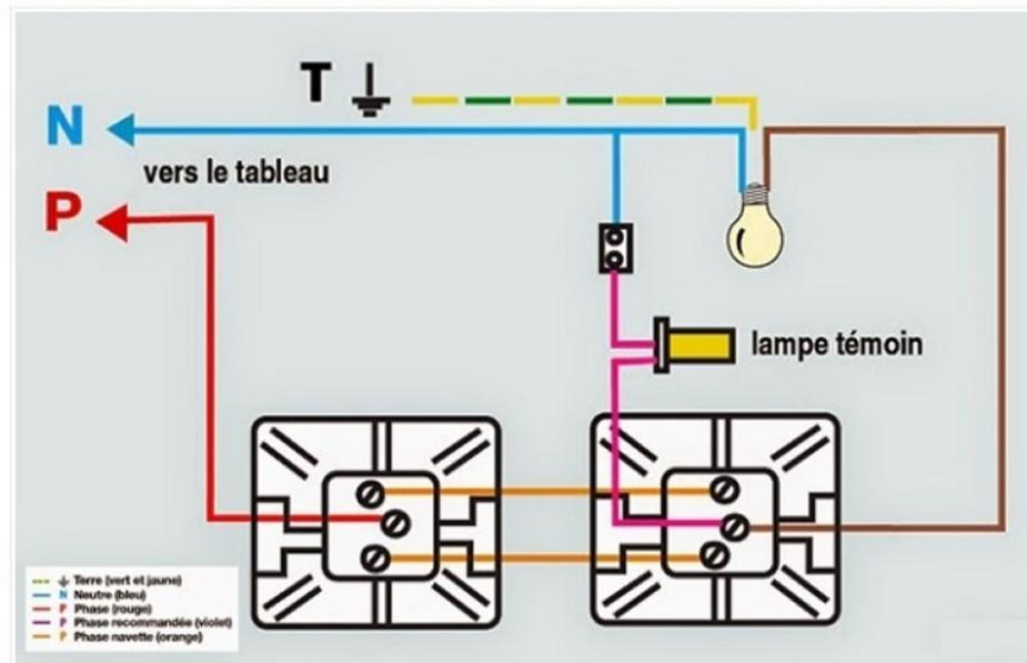
installation va et vient avec témoin lumineux les deux interrupteurs
